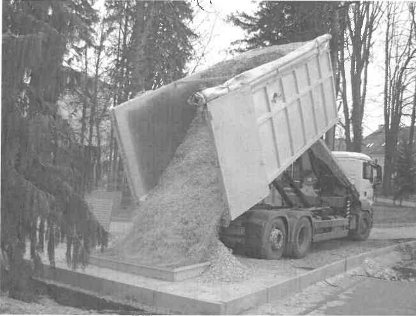
Slika 4: Vsipanje lesnih sekancev v skladišče pod nivojem terena, nad katerim je urejeno parkirišče (Vsip v SGLŠ Postojna)
